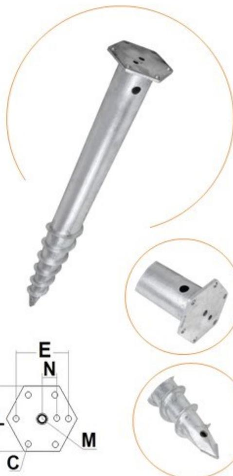
Acero estructural S235, clase 4.6, Re 235 MPa, galvanizado en caliente según EN ISO 1461.
